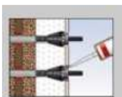
Faza 9: umpleți spațiul circular cu siliconul de fixare
