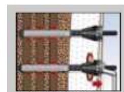
Faza 8: reglați adâncimea MTH THERMAX în funcție de necesități
